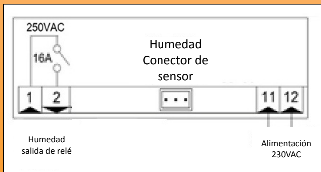
Diagrama de cableado del controlador de humedad
